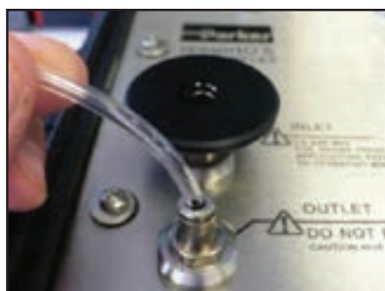
Conecte uma mangueira de SAÍDA (ø 4 mm)
